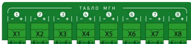
Рисунок 35. Клеммы «ВЫХОД ТАБЛО МГН 1 – 8» для подключения табло МЕТА 7523 и МЕТА 7523 исп.1 к БС МЕТА 17560.
